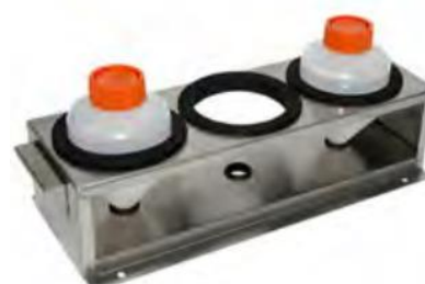
Uchwyt na próbki bioreakcyjne 450ml lub 600ml
